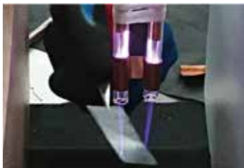
高周波電磁波生成の大気圧プラズマ (He)による 金属表面 (Al) とCFRPの改質実験
